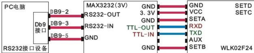
备注: 目前很多最新电脑已经没有DB9接口,那可以采用USB转串口形式
