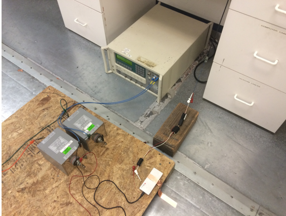
图 74. IEC 61000-4-5 浪涌测试装置
