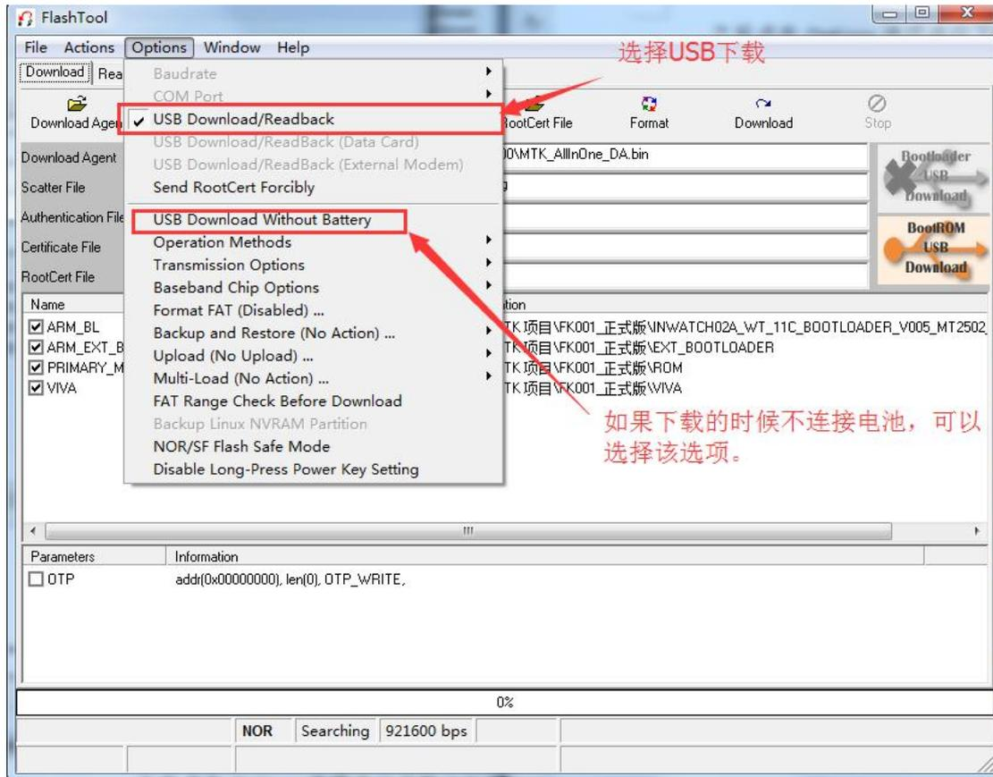
设置好接口之后，就可以进行下载了，这里要保证上面的 USB 驱动安装成功。先点击
