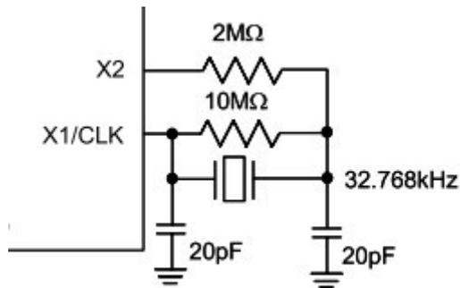
一份电路在其输出端串接了一个 22K 的电阻，在其输出端和输入端之间接了一个 10M 的电阻，这是由于连接晶振的芯片端内部是一个线性运算放大器，将输入进行反向 180 度输出，晶振处的负载电容电阻组成的网络提供另外 180 度的相移，整个环路的相移 360 度，满足振荡的相位条件，同时还要求闭环增益大于等于 1，晶体才正常工作。
