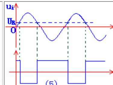
简单的电压比较器结构简单，灵敏多高，但是抗干能力差，因此我们就要对它进行改进。改进后的电压比较器有：滞回比较器和窗口比较器。在此对它们不作要求。
