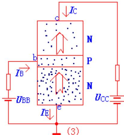
其中： $I_{CEO}$  为发射结少数载流子形成的反向饱和电流； $I_{CBO}$  为  $I_B=0$  时，集电极和发射极之间的穿透电流。
