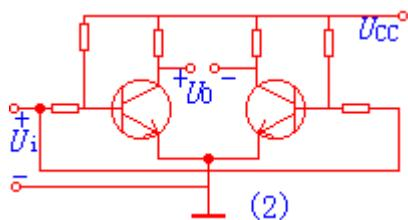
共模信号的作用，对两管的作用是同向的，将引起两管电流同量的增加，集电极电位也同
