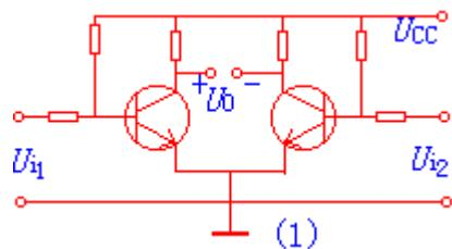
它的工作原理是：当输入信号  $U_i=0$  时，则两管的电流相等，两管的集电极电位也相等，所以输出电压  $U_o=U_{c1}-U_{c2}=0$ 。温度上升时，两管电流均增加，则集电极电位均下降，由于它们处于同一温度环境，因此两管的电流和电压变化量均相等，其输出电压仍然为零。
