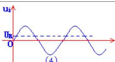
解：输出波形与  $U_R$  有关，输出波形如图（5）所示
