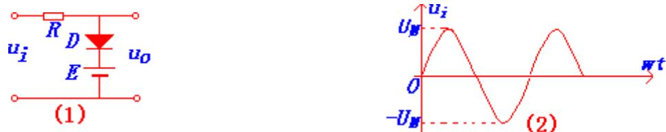
(1)  $E=0$  时限幅电平为  $0V$ 。 $u_i > 0$  时二极管导通,  $u_o = 0$ ,  $u_i < 0$  时, 二极管截止,  $u_o = u_i$ , 它的波形图为: 如图 (3) 所示
