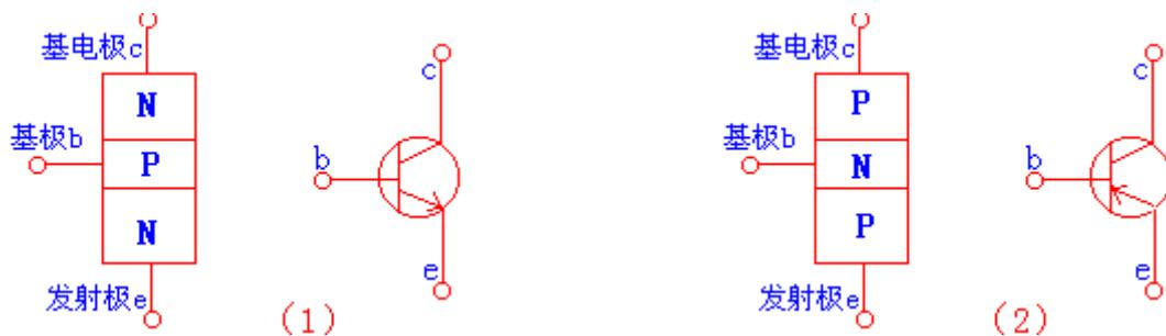
不管是什麽样的三极管，它们均包含三个区：发射区，基区，集电区，同时相应的引出三个电极：发射极，基极，集电极。同时又在两两交界区形成 PN 结，分别是发射结和基点结。
