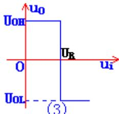
定义：阈值电压：我们将比较器的输出电压从一个电平跳变到另一个电平时对应的输入电压的值。它还被称为门限电压。简称为：阈值。用符号  $U_{th}$  表示。
