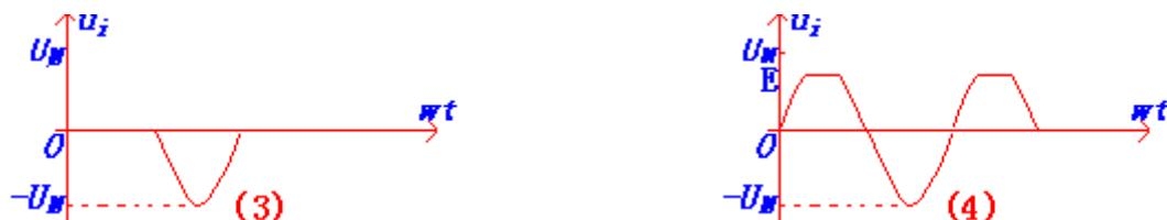
(2) 当  $0 < E < U_M$  时, 限幅电平为  $+E$ 。 $u_i < +E$  时, 二极管截止,  $u_o = u_i$ ;  $u_i > +E$  时, 二极管导通,  $u_o = E$ , 它的波形图为:如图(4)所示
