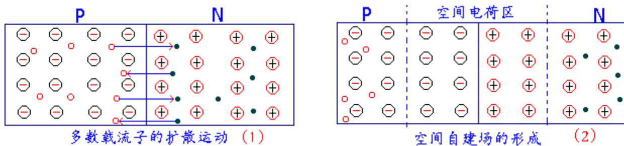
在电场的作用下，载流子将作漂移运动，它的运动方向与扩散运动的方向相反，阻止扩散运动。电场的强弱与扩散的程度有关，扩散的越多，电场越强，同时对扩散运动的阻力也越大，当扩散运动与漂移运动相等时，通过界面的载流子为 0。此时，PN 结的交界区就形成一个缺少载流子的高阻区，我们又把它称为阻挡层或耗尽层。
