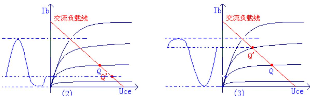
由于放大电路有失真问题，因此它存在最大不失真输出电压幅值  $U_{om}$ 。最大不失真输出电压是指：当工作状态一定的前提下，逐渐增大输入信号，三极管还没有进入截止或饱和时，输出所能获得的最大电压输出。
