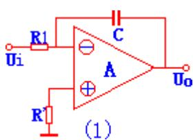
它的输入、输出电压的关系为： $u_o = \frac{-1}{RC} \int_{t_0}^t u_i dt + u_c|_{t=0}$  其中： $u_c|_{t=0}$  表示电容两端的初始电压值。如果电路输入的电压波形是方形，则产生三角波形输出。
