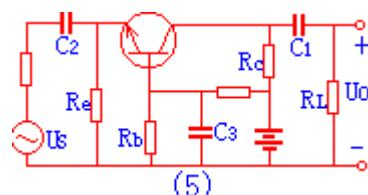
因为:  $U_o = -\beta I_b R'_L \quad R'_L = R_C // R_L$
