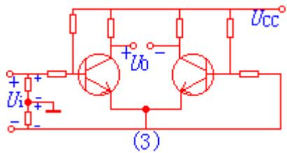
差模信号的作用，由于信号的极性相反，因此 T1 管集电极电压下降，T2 管的集电极电压上升，且二者的变化量的绝对值相等，因此： $U_{od} = U_{c1} - U_{c2} = 2U_{c1}$  ( $\approx 2U_{c2}$ )
