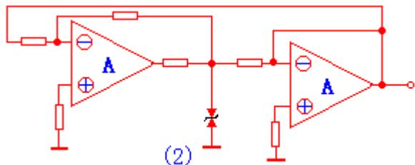
它的前级集成运放组成滞回比较电路，后级组成积分电路。它可同时产生方波(前级集成运放产生)和三角波(后级集成运放产生)。
