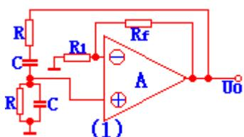
串并联网络在此作为选频和反馈网络。它的电路图如图 (1) 所示：
