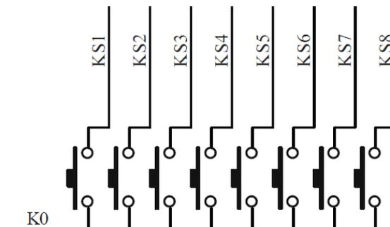
键扫数据储存地址如下所示，先发读键命令后，开始读取按键数据 BYTE1—BYTE4 字节，读数据从低位开始输出。芯片 K 和 KS 引脚对应的按键按下时，相对应的字节内的 BIT 位为 1。
