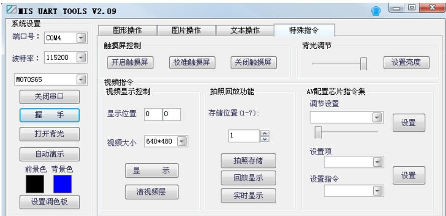
接着点击“校准触摸屏”按钮。此时我们注意，液晶屏被清屏为白色了，但是在液晶屏的右上角有一个蓝色正方形（如图所示），大家找只触摸笔点击一下那个蓝色正方形，当然是位置越准确越好。点击完后，蓝色正方形就跑到左下角了，接着是右下角，最后是右上角，大家都分别尽可能准确的点击一下。完成好触摸屏校准就 OK 了。
