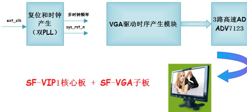
SF-VIP1 核心板的 OUTPPN 插座 P4 连接到 SF-VGA 子板的 P1。SF-VIP1 核心板和 SF-VGA 子板的连接示意如下图所示。
