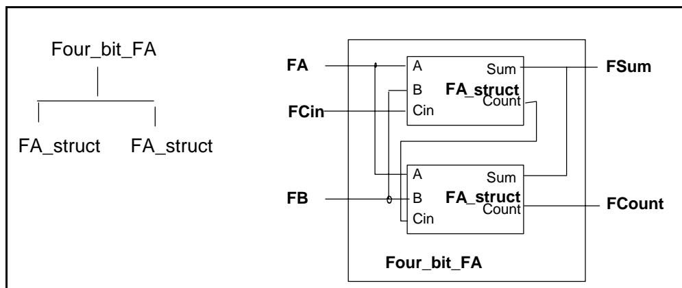
图5 两位全加器的结构示意图
