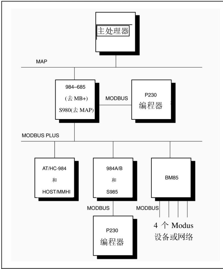
图 1: Modbus 协议应用示意图
