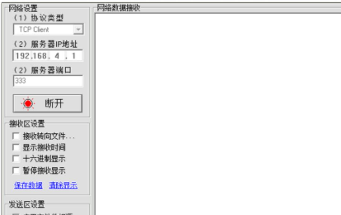
注意：ESP8266 作为 TCP server 有超时机制，如果连接建立后，一段时间内无数据来往，ESP8266 TCP server 会将 TCP client 踢掉。请在 PC 网络工具连上 ESP8266 后建立一个 2s 的循环数据发送，用于保持连接。
