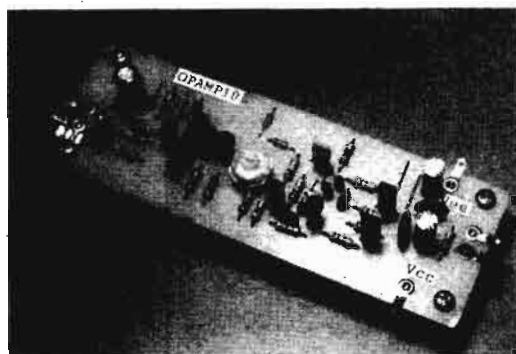
照片 5.4 完成后的 10 管大输出电流放大器的电路板
