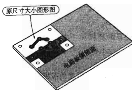
图 A1 将原尺寸大小图形覆盖在铜箔面上用玻璃胶带进行固定
