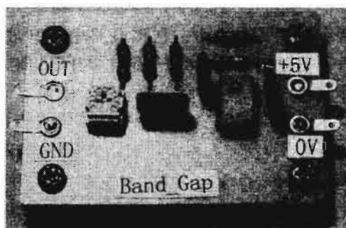
照片 5.13 完成后的带隙型稳压电路
