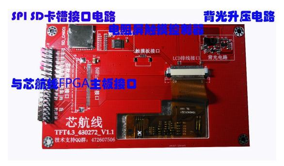
本模组实现了对电阻触摸屏的模拟信号采样电路。并将 TFT 屏的 24 位颜色数据转化为 16 位数据, 然后通过 34 针排针接口, 最后与芯航线 FPGA 主板相连。
