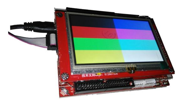
通过照片可知,TFT 控制器设计能够稳定正确的刷新 TFT 显示屏并控制正确的显示位置,因此设计无误。
