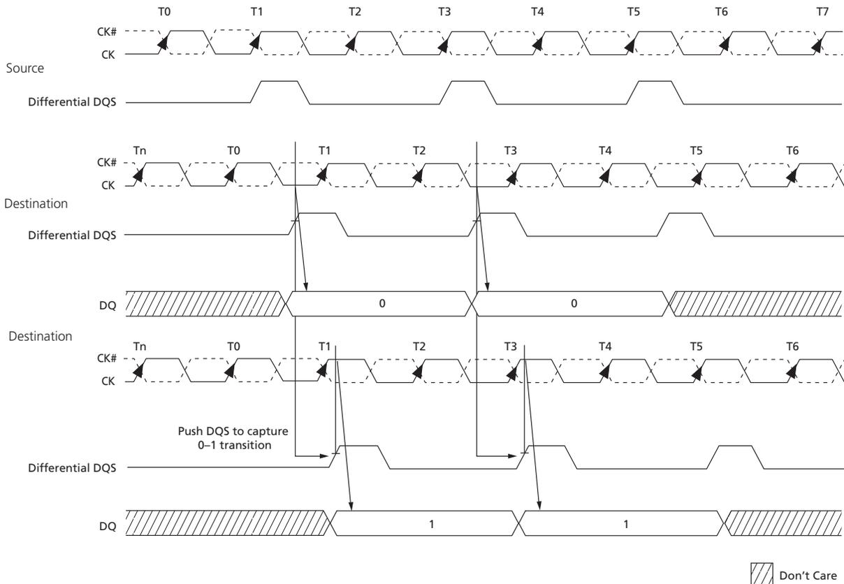
When write leveling is enabled, the rising edge of DQS samples CK, and the prime DQ outputs the sampled CK's status. The prime DQ for a x4 or x8 configuration is DQ0 with all other DQ (DQ[7:1]) driving LOW. The prime DQ for a x16 configuration is DQ0 for the lower byte and DQ8 for the upper byte. It outputs the status of CK sampled by LDQS and UDQS. All other DQ (DQ[7:1], DQ[15:9]) continue to drive LOW. Two prime DQ on a x16 enable each byte lane to be leveled independently.
