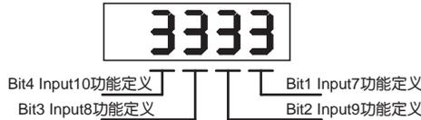
Bit1定义输入引脚X7作为PID控制器的全局增益选择功能:
