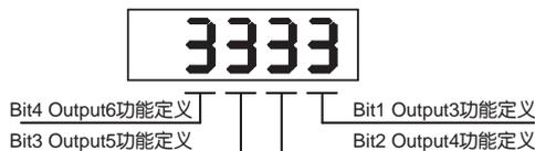
Bit1定义输出引脚Y3的运动控制输出功能，该引脚上可定义5种功能：
