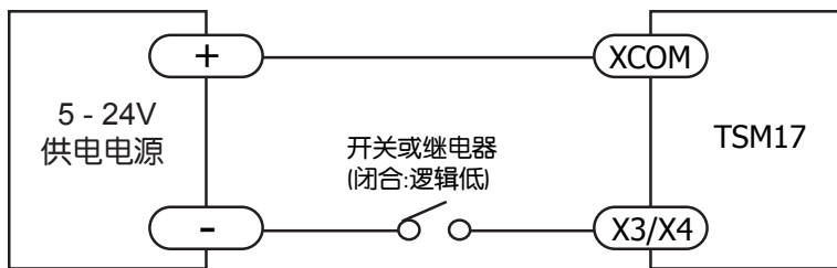
使用开关或继电器的连接方式
