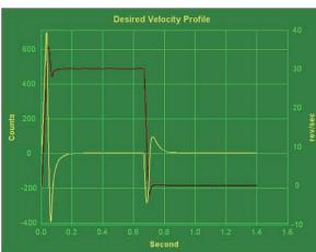
机器设备执行参数自动整定前，刚性及定位效果较差
