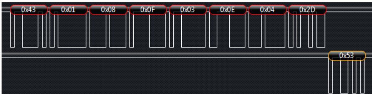
注意：校验成功后触控 IC 会根据当前命令进行设置，如果触控 IC 在上电 2s 内都无法收到正确的设置信息，IC 会保持以前的灵敏度设定值，如果用户从来没有设置过灵敏度，IC 默认选择第 8 等级灵敏度。如果在 IC 上电 2s 后用户再发送灵敏度设置信息，此时 IC 将不会回复任何信息。灵敏度等级设置信息的长度与用户使用的 TK 通道个数无关，固定为 6 个 Byte，当用户使用的 TK 通道小于 6 个时，用户也应该依次将 TK0-TK5 的灵敏度等级写入，不使用的通道用户可以设置任意值，建议设置为 0x0F。
