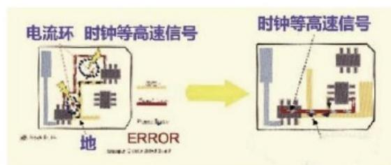
所有的高速信号必须有良好的回流路径。尽可能地保证时钟等高速信号的回流路径最小。否则会极大的增加辐射，并且辐射的大小和信号路径和回流路径所包围的面积成正比。
