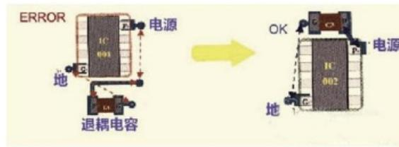
退耦电容的摆放的位置非常的重要。摆放不合理根本起不到退耦的效果。其原则是：靠近电源的管脚，并且电容的电源走线和地线所包围的面积最小。
