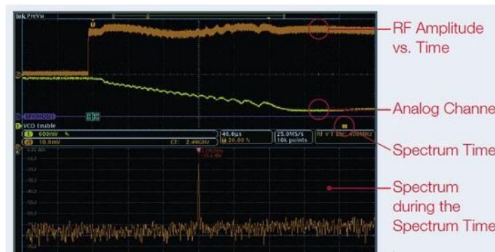
图6：这张图显示了MDO提供的时间关联观察功能，图中显示了射频幅度与时间的关系轨迹。
