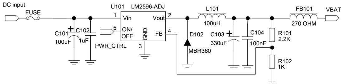
图 7: DC-DC 电源参考电路
