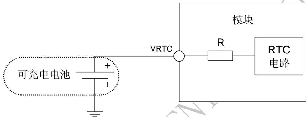
图 18: 可充电电池给 RTC 供电
