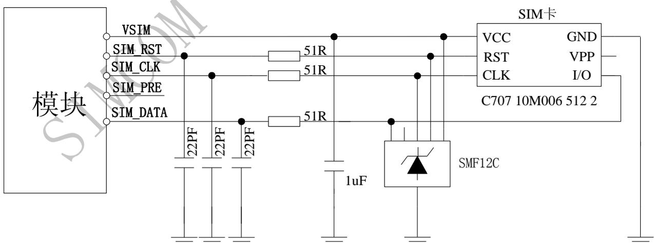
图 33：6 引脚 SIM 卡座的接口推荐电路
