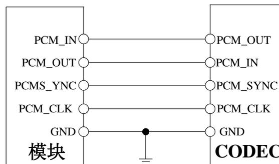
图 36: PCM 连接图
