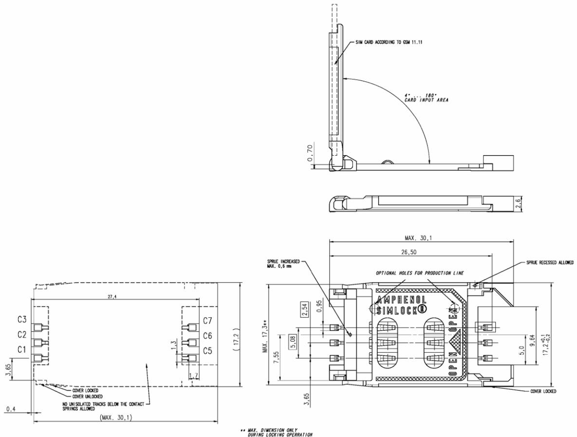
图 35: Amphenol C707 10M006 5122 SIM 卡座尺寸图
