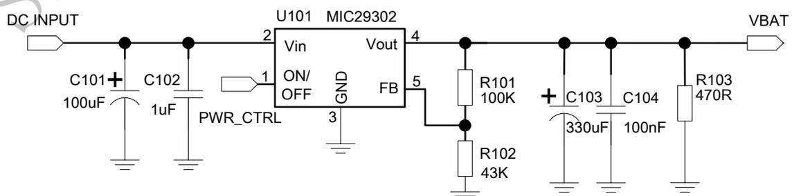
图 6: LDO 供电参考电路
