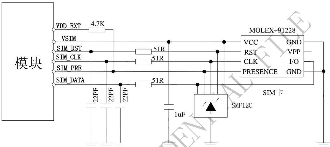
图 32：8 引脚 SIM 卡座的接口推荐电路
