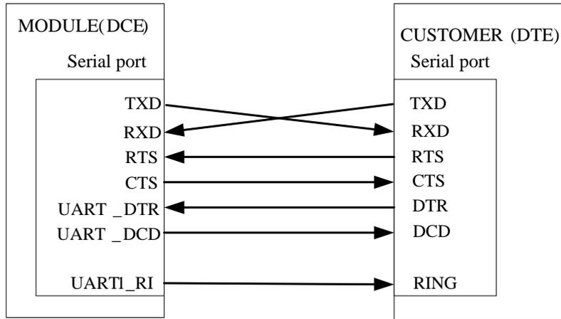
图 19: 串口连接图
