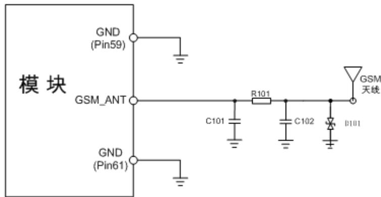
图 46: GSM 天线接口简化连接电路
