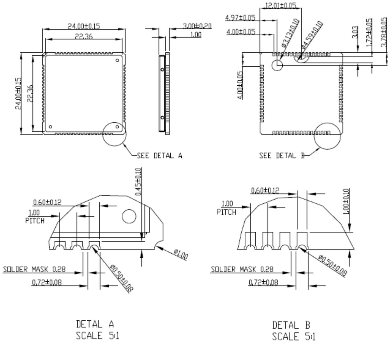
图 3: 三维尺寸 (单位: 毫米)
