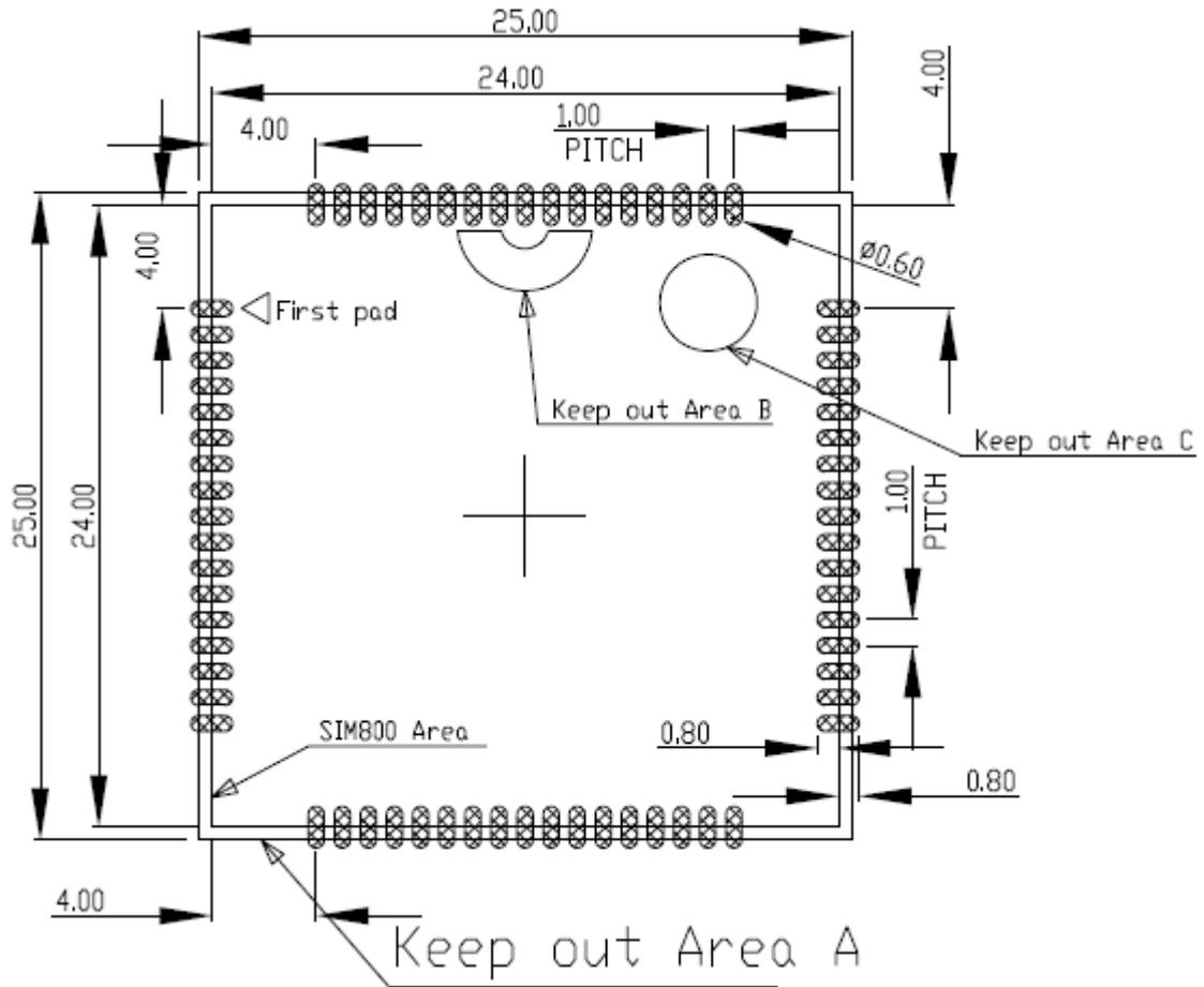
图 4: 推荐 PCB 封装尺寸 (单位: 毫米)
