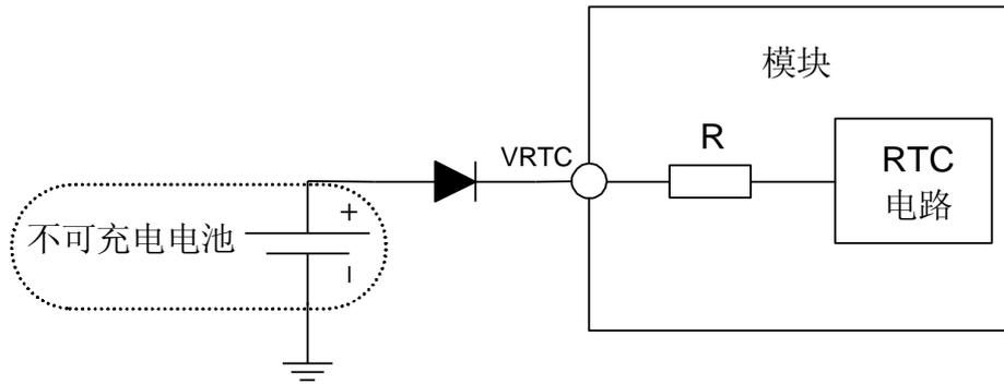
图 17: 不可充电电池给 RTC 供电
