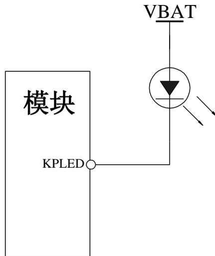
图 43: KPLED 驱动电路连接示意图
