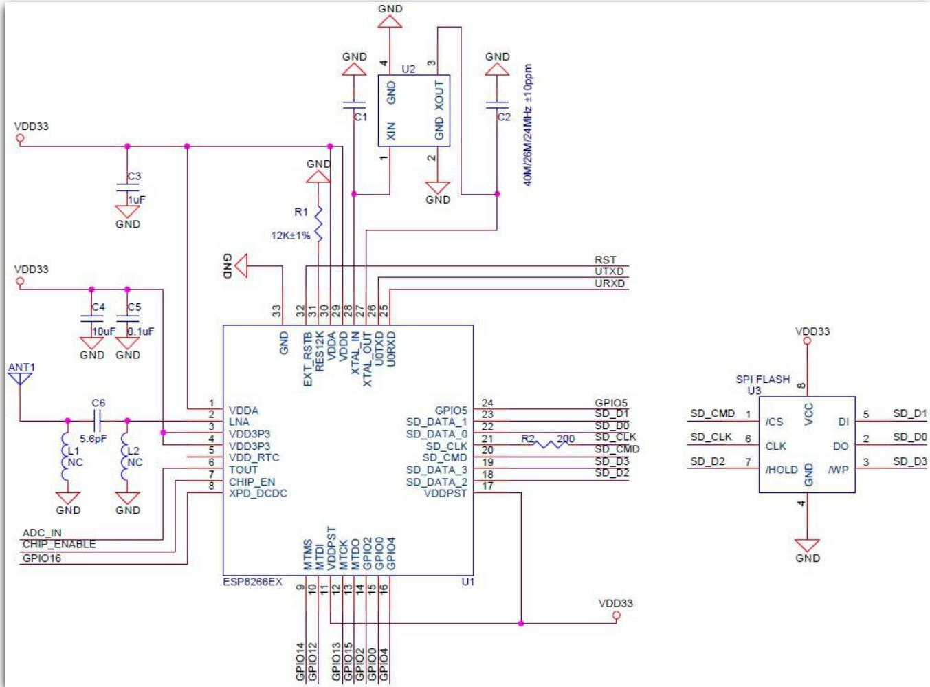
图 5 ESP-12F 原理图
