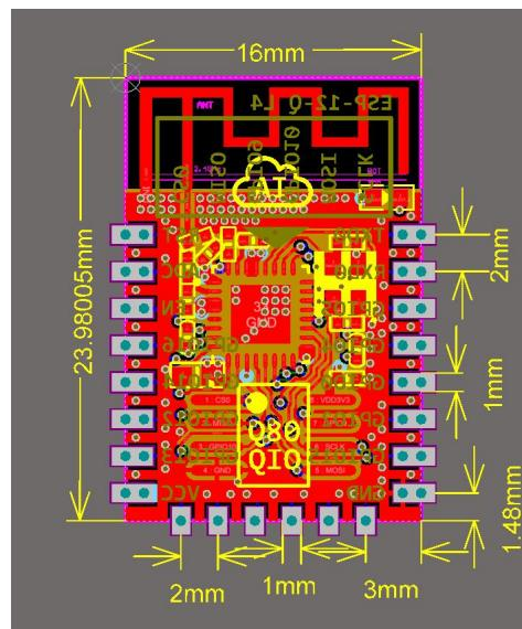
图 4 ESP-12F 模组尺寸平面图
