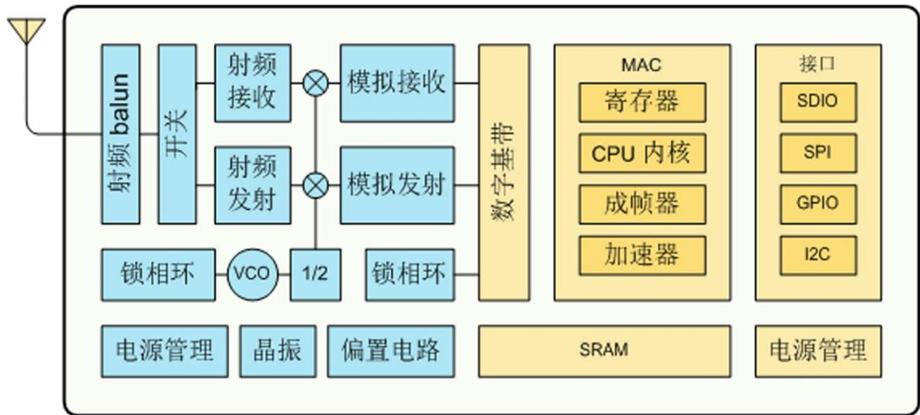
图 1 ESP8266EX 结构图
