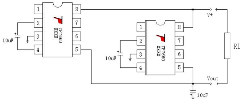
$$\text{输出电阻近似为: } \frac{R_{OUT} \text{ (单芯片的)}}{n \text{ (并联芯片数)}}$$
