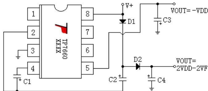
在此图中，C1,C3 分别是负电压电路的泵电容与存储电容，C2,C4 分别是倍压电路的泵电容与存储电容。输入电压为+5V 时，可同时得到+9V 与-5V 的输出电压。
