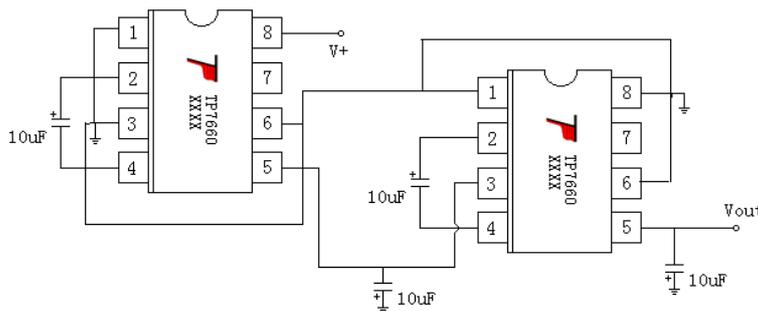
由于单个芯片的电源效率有限, 实际应用中级联的芯片数也是有限的。此种情况下, 输出电阻近似为每个芯片阻值的  $n$  倍 ( $n$  为级联芯片数)。
