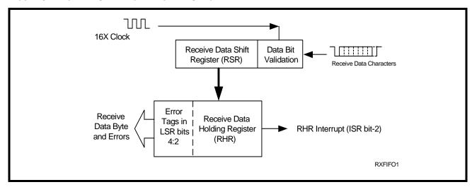
FIGURE 9. RECEIVER OPERATION IN FIFO
