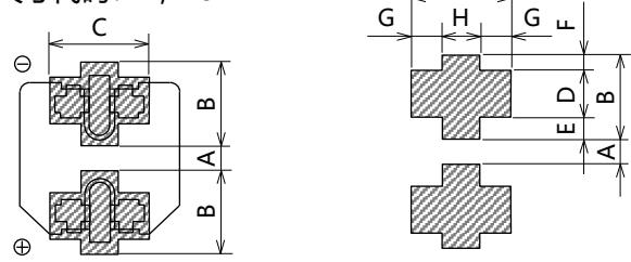
(推荐电路板焊盘尺寸)
