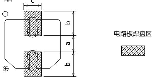
(推荐电路板焊盘尺寸)
