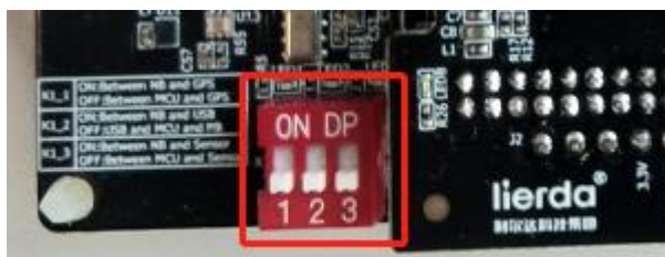
图 2-4 NB86-EVK-B 板模拟水表拨码开关示意图
