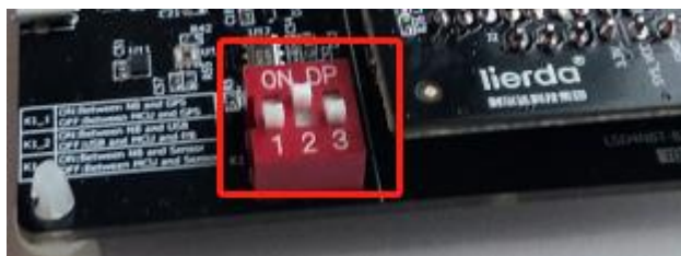
图 4-3 NB86-G 模组固件拨码开关示意图
