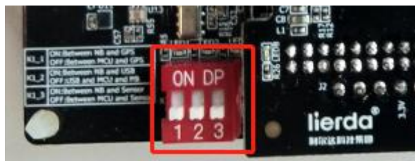
图 4-5 拨码开关示意图
