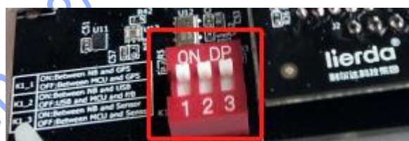
图 2-3 NB86-EVK-A 板模拟水表拨码开关示意图
