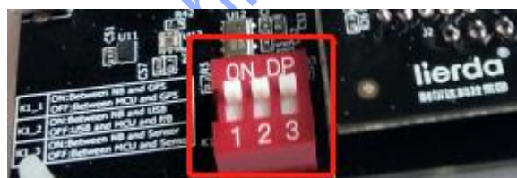
图 3-1 NB86-G 模组烧写固件拨码开关示意图
