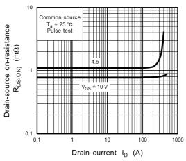
Fig. 8.5 R<sub>DS(ON)</sub> - I<sub>D</sub>
