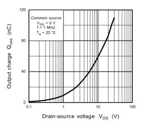
Fig. 8.12 Q<sub>oss</sub> - V<sub>DS</sub>
