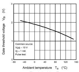
Fig. 8.8 V<sub>th</sub> - T<sub>a</sub>
