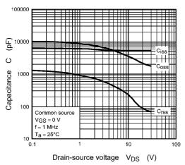
Fig. 8.11 Capacitance - V<sub>DS</sub>
