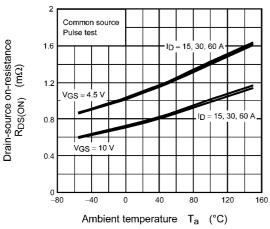
Fig. 8.9 R<sub>DS(ON)</sub> - T<sub>a</sub>
