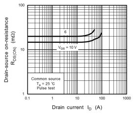
Fig. 8.5 R<sub>DS(ON)</sub> - I<sub>D</sub>
