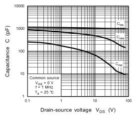
Fig. 8.11 Capacitance - V<sub>DS</sub>
