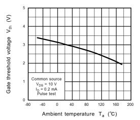
Fig. 8.8 V<sub>th</sub> - T<sub>a</sub>
