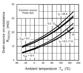
Fig. 8.9 R<sub>DS(ON)</sub> - T<sub>a</sub>
