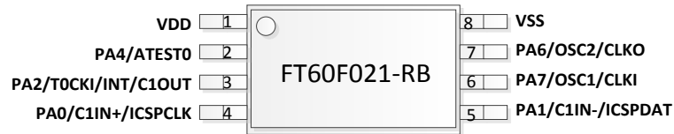
图 1.3 SOP-8 脚位图
