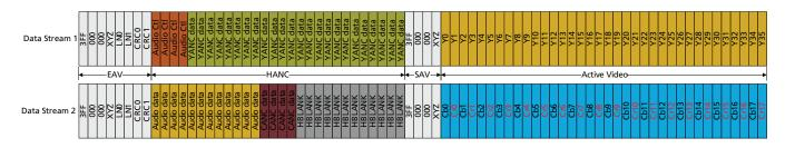
Figure 4-1: Level A Mapping
