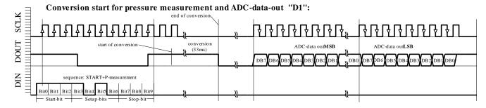
Fig. 6a: D1 ACQUISITION sequence
