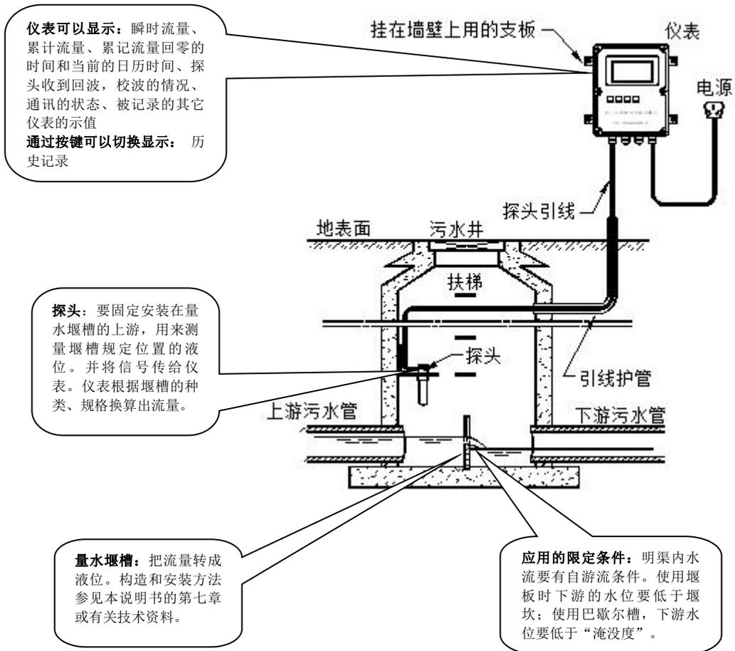
图一、TD-1D 型超声波明渠流量计用于测污水流量
