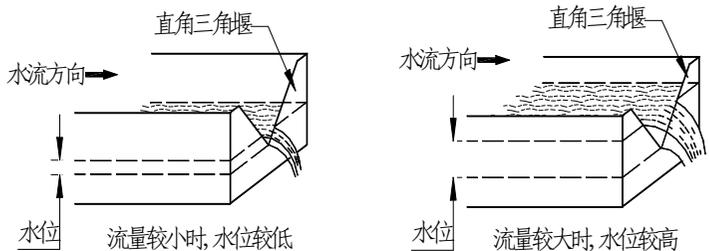
图五 a、量水堰槽把流量转成液位
