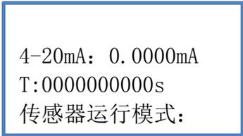
当安装高度设置为 0.000m 时，仪表显示传感器到水面（或堰槽底部）距离，此时，流量计不进行流量计算。
