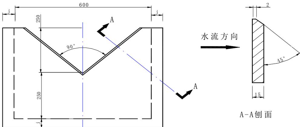
材料：玻璃钢； 要求：1，板面光滑、平整、无扭曲；2，三角口缘台要平直、光滑。
