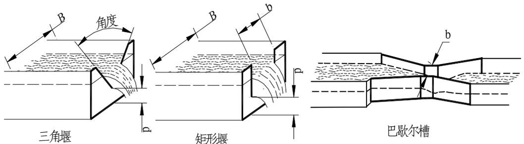
图五 b、常用的量水堰种类
