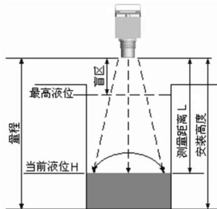
当安装高度设置为  $0.000\text{m}$  时, 仪表显示传感器到水面 (或堰槽底部) 距离, 此时, 流量计不进行流量计算。
