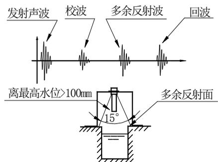
点就变化了，影响测量的准确度。探头要垂直对准水面，不能歪斜。
