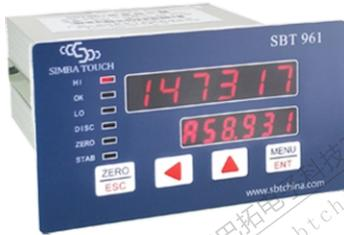
用于需要将测力信号转换为数字通讯信号、标准模拟输出信号及简单控制的场合。模拟输出信号可选择0-20mA、4-20mA、0-10V、1-5V，数字通讯接口可选择RS485或RS232，均带隔离。双排6位LED数码管分别显示实时测量值、峰值、输出电流值、I/O状态信息。
