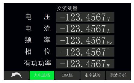
点击"大电流档"或者"10A 档"选择对应的档位,"大电流档"在直接穿孔测量时使用,"10A档"在接入 10A 小电流档时使用。
