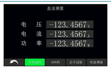
点击"大电流档"或者"10A 档"选择对应的档位,"大电流档"在直接穿孔测量时使用,"10A档"在接入 10A 小电流档时使用。
