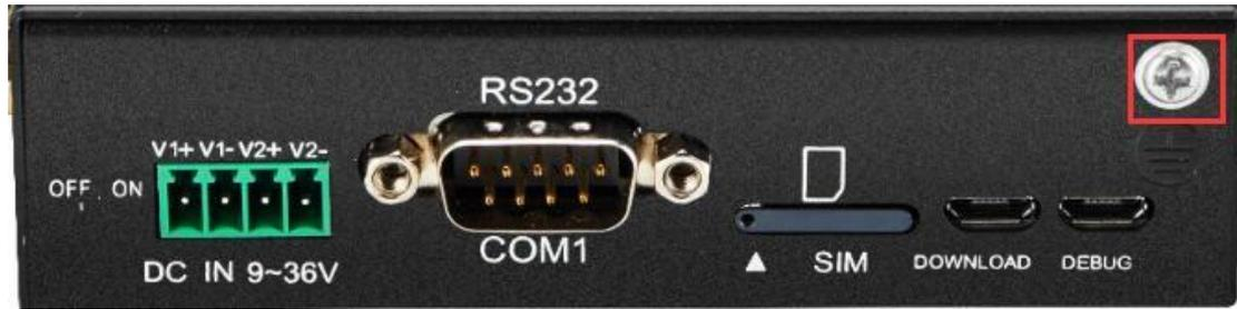
BL110 网关接地线有助于防止电磁干扰带来的影响。在连接设备之前，先通过接地螺丝接线让设备接地。
