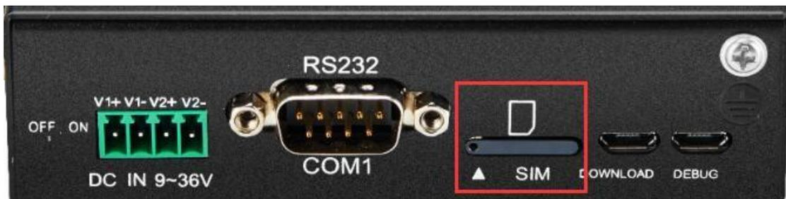
插入/移除 SIM 卡时，先确保设备已关机，用取卡针插入卡槽小孔，稍微用力按下将卡槽顶出来。
