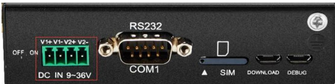
BL110 网关提供两路可选输入端口，支持 DC 9~36V 输入，支持反接防护。
