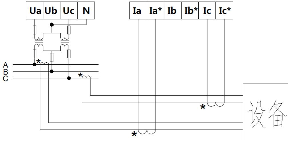
三相三线(电压、电流经互感器接入)
