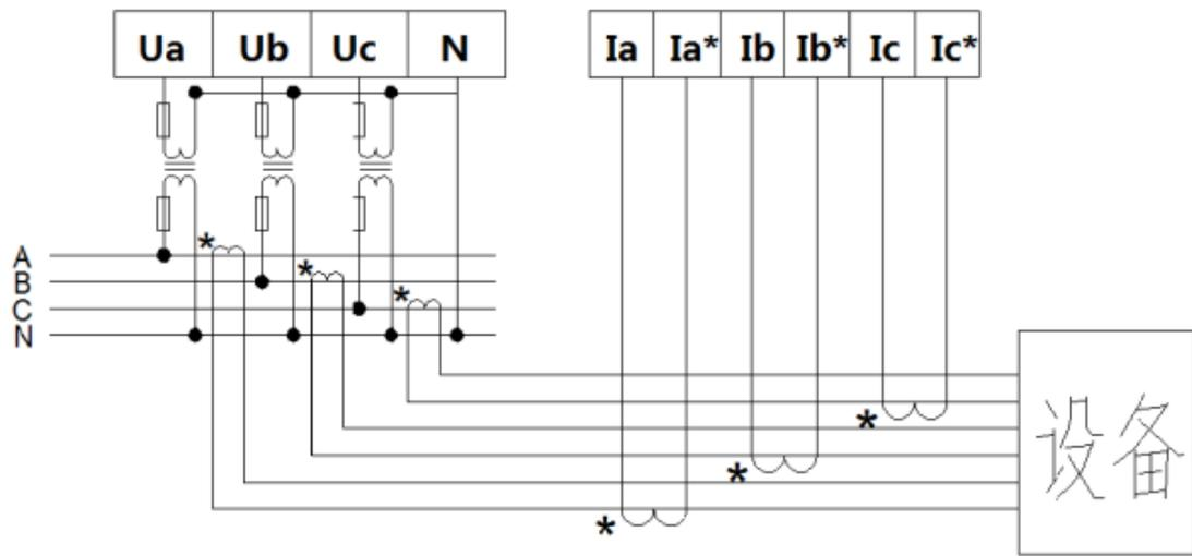
三相四线(电压、电流经互感器接入)
