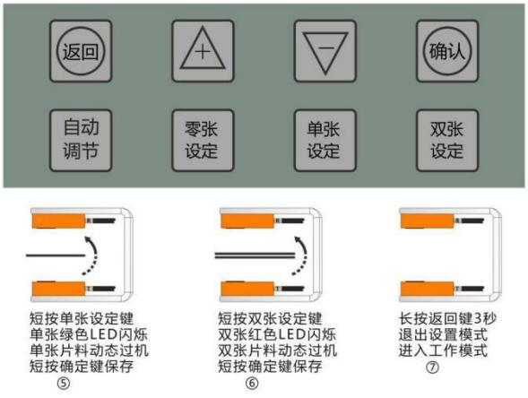
⑤在设置模式下（长按“确定”键3秒），短按“单张设定”键，此时“单张”绿色指示灯闪烁。控制送料系统正常传送一张片料（动态过机），短按“确认”键保存，完成单张动态学习。
