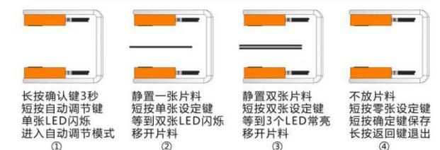
①长按“确认”键 3 秒, 直到液晶屏点亮, 进入设置模式, 短按“自动调节”键, 此时“单张”指示灯闪烁, 进入自动调节模式。
