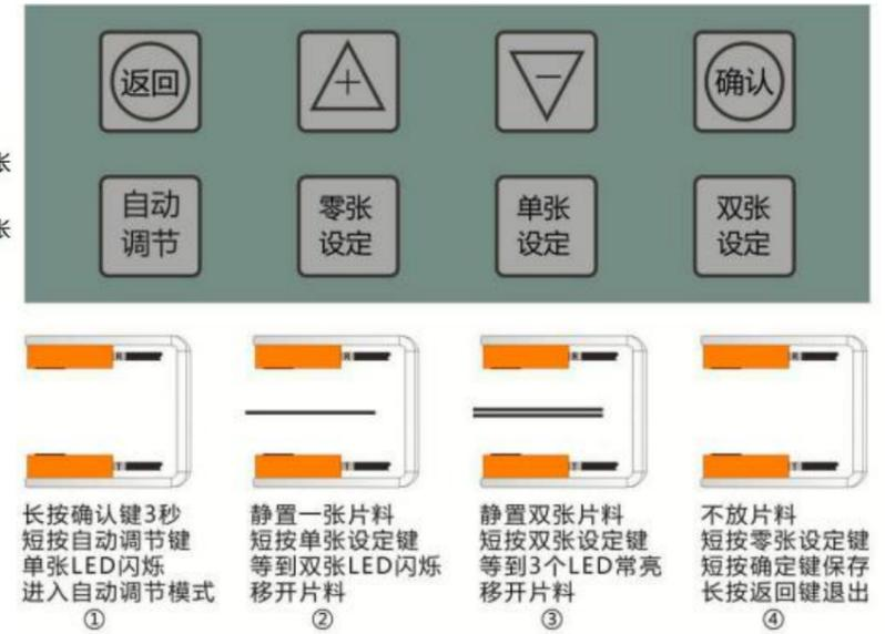
①长按“确认”键 3 秒，直到液晶屏点亮，进入设置模式，短按“自动调节”键，此时“单张”指示灯闪烁，进入自动调节模式。
