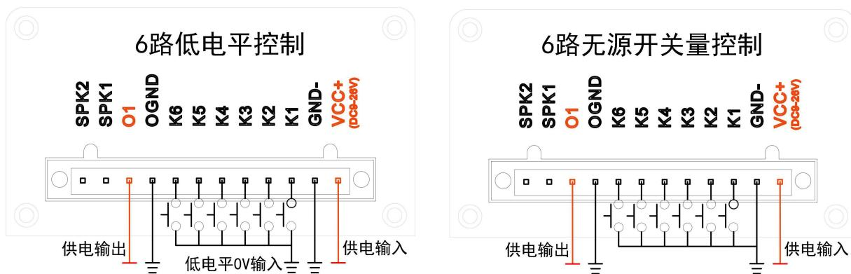
※供电接 VCC+, GND-；K1-K6：给低电平信号或与 GND 触发播放第 1-6 段音频；
