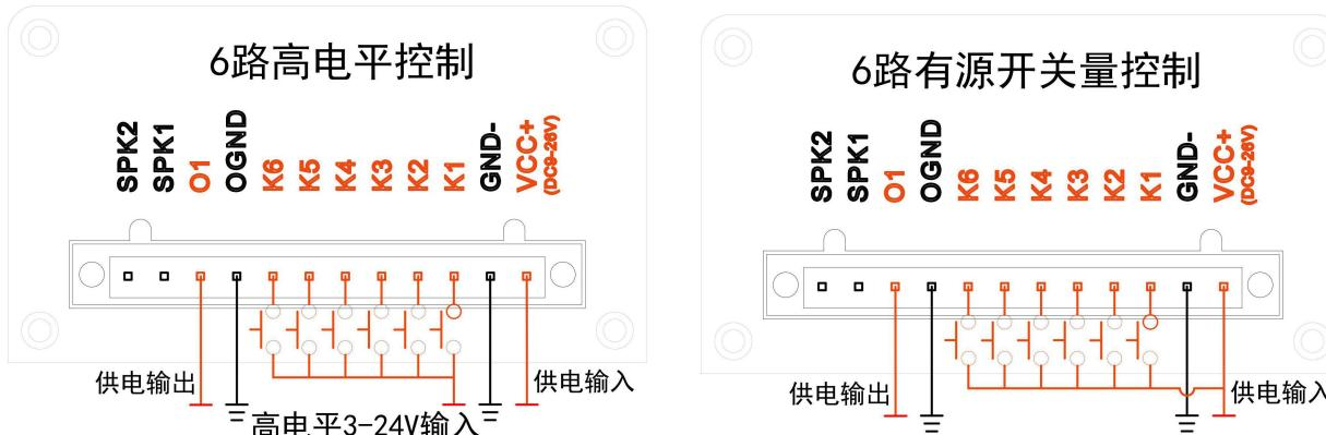
※供电接 VCC+, GND-；K1-K6：给高电平信号或与 VCC 触发播放第 1-6 段音频；
