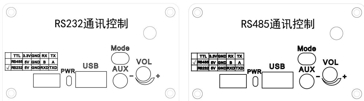
※白色端口：支持 RS232 串口通讯（注意打√处），供电接 VCC+, GND-，端子线对接 GND, RXD, TXD 即可
