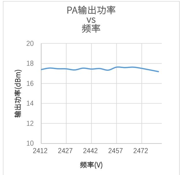
图 4-2 输出功率 vs 频率
