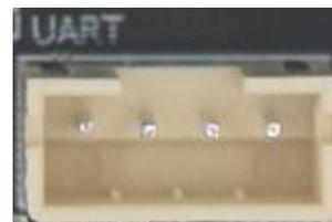
1：此串口可通过硬件调整，配置为 TTL / RS232 的形式与外部设备进行数据连接
