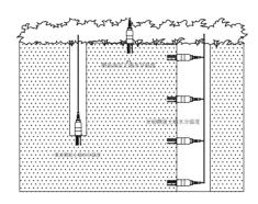
土壤水分传感器准确安装方法根据以上的原则, 可参考以 下基本方法来完成高质量的安装(如上图的方法)。
