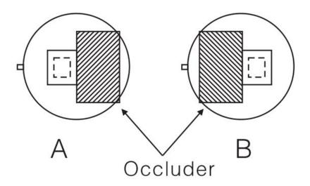
双元传感器的灵敏平衡度是通过测量每个单元的灵敏度(即单个输出峰值电压),并采用下列公式计算得出。
