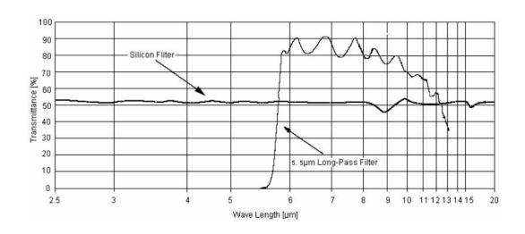
注意:图表所示为典型的 5µ m 红外滤光片参考图,曲线是红外线通过率的平均值。 该窗口材料是经过特殊真空镀膜处理过的半导体硅片。
