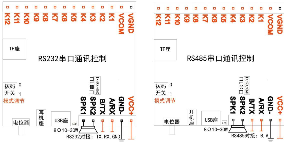
※RS232 版: 供电接 VCC+, GND-; 通讯口接 RX, TX, GND, 即可 RS232 串口通讯控制播放, 同时支持标准版功能;
