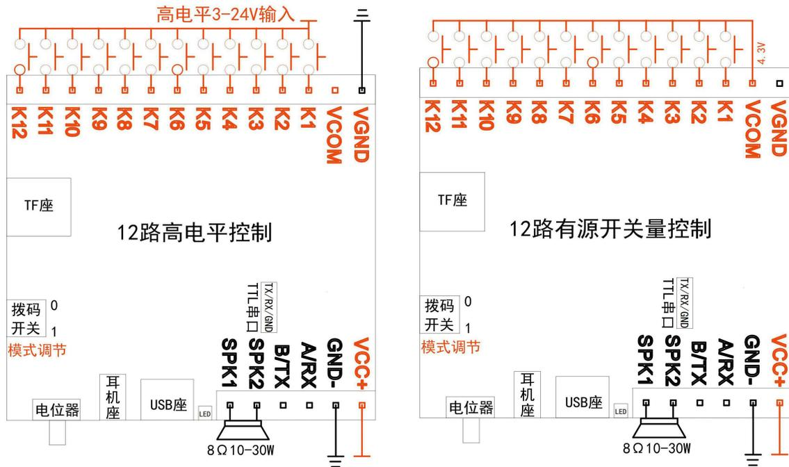
※供电接 VCC+, GND-; K1-K12: 给高电平信号或与 VCOM 触发播放第 1-12 段音频;
