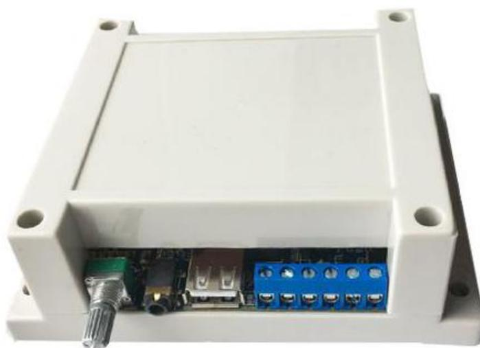
BY-F810是深圳市百为电子科技有限公司自主研发的一款专门针对工业控制市场的高稳定性大功率输出的插卡语音播放板。此语音播放板支持外接10-30W高音质喇叭，自带128M TF存储卡，支持读U盘，支持12路高电平/有源开关量控制（标准版），支持255路RS232串口通讯控制（RS232版），支持255路RS485串口通讯控制（RS485版），支持6路无线遥控器控制，自带有多种保护电路。
