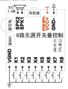
※供电接 VCC+, GND-; K1-K8: 给低电平信号或与 GND 触发播放第 1-8 段音频; 注意: 外接低电平信号控制时,如信号来源的供电与播放板不是同一个电源,需要共地;
