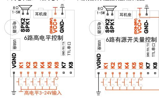
※供电接 VCC+, GND-; K1-K6: 给高电平信号或与 VCC 触发播放第 1-6 段音频; 注意:外接高电平信号控制时,如信号来源的供电与播放板不是同一个电源,需要共地;
