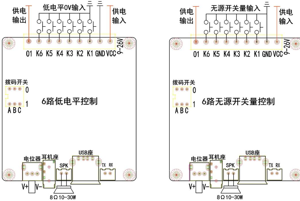
※供电接 VCC+, GND-; K1-K6: 给低电平信号或与 GND 触发播放第 1-6 段音频;
