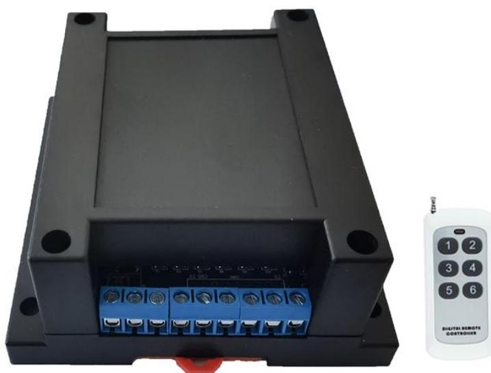
BY-F910 是深圳市百为电子科技有限公司自主研发的一款专门针对工业控制市场的高稳定性自带内存的语音播放板。此语音播放板自带功放支持驱动10~30W无源喇叭，自带8M BYTE FLASH存储芯片，支持读U盘，支持6路一对一输入控制语音播放，支持1路输出电源信号可外接警灯或其他设备，支持TTL、232、485串口通讯控制。板载拨动开关可实现8种播放模式切换实现不同的控制功能，自带有多种保护电路。目前有四种版本：标准版、高电平版、232通讯版、485通讯版、遥控版。
