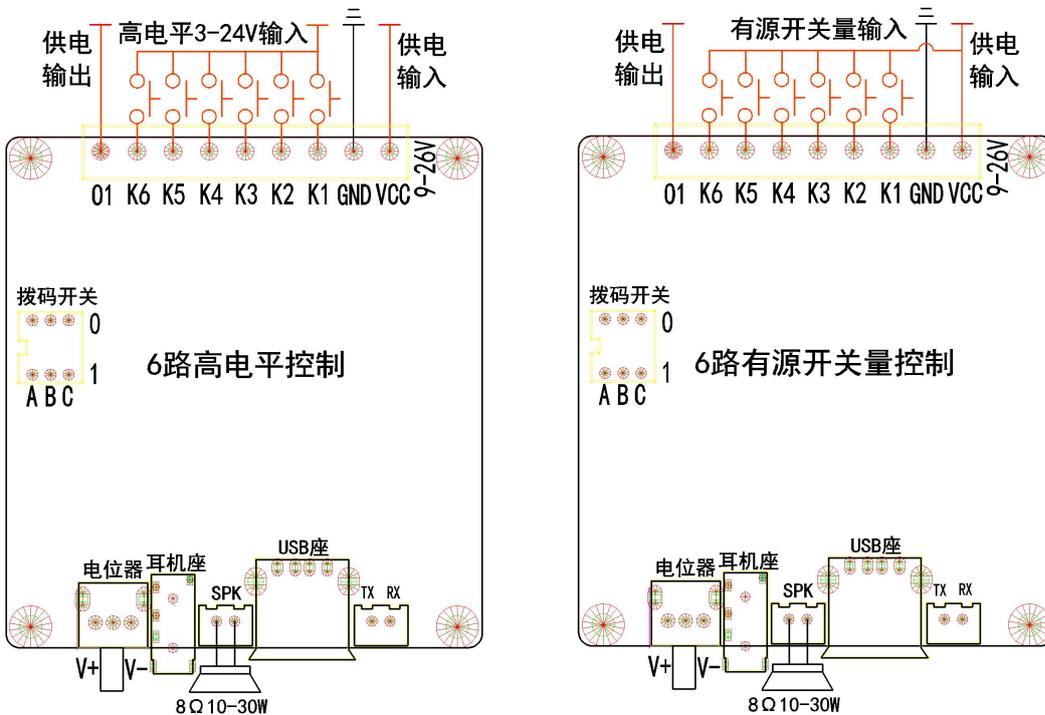
※供电接 VCC+, GND-; K1-K6: 给高电平信号或与 VCC 触发播放第 1-6 段音频;
