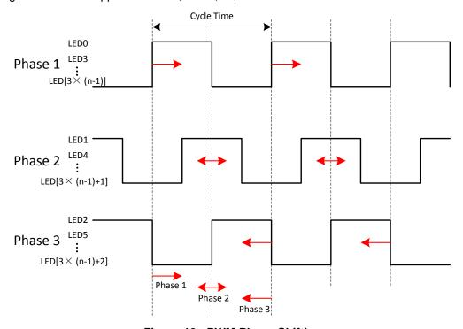
Figure 12. PWM Phase-Shifting
