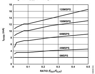
Figure 35. I<sub>DVDD</sub> vs. Ratio @ DVDD1 = DVDD2 = 3.3 V
