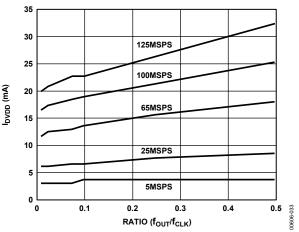
Figure 34.  $I_{DVDD}$  vs. Ratio @ DVDD1 = DVDD2 = 5 V
