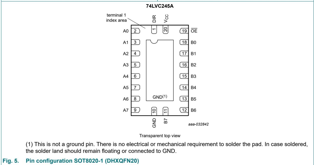
Fig. 5. Pin configuration SOT8020-1 (DHXQFN20)
