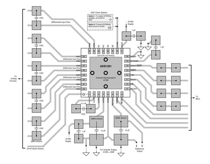
Figure 103. ADS1261 Layout Example
