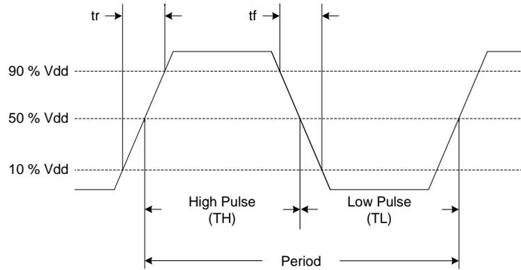
**Figure 15. LVCMOS Waveform Diagram<sup>[13]</sup>**
